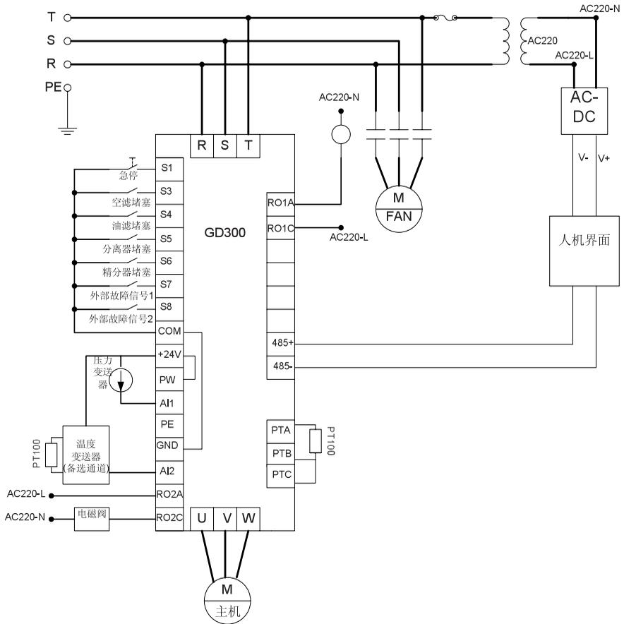
上图的温度检测通道 PT100 通过 P18.03 选择，出厂设定为温度检测端子（PTA、PTB、PTC）；温度变送器可根据现场需求设置（P18.03=0），一般无需配置。
