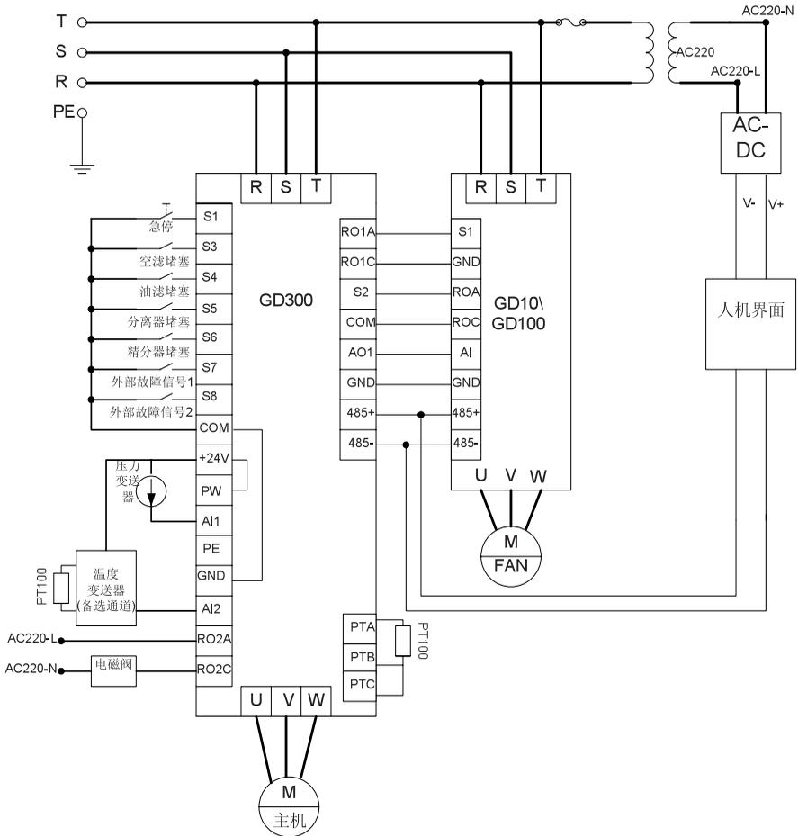
上图的温度检测通道 PT100 通过 P18.03 选择，出厂设定为温度检测端子（PTA、PTB、PTC）；温度变送器可根据现场需求设置（P18.03=0），一般无需配置。
